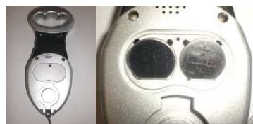
Legen Sie die Batterien wie in den Abbildungen beschrieben gemäß der angegebenen Polungen (+ nach oben) in das Batteriefach ein und verschließen es wieder.
