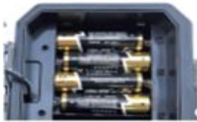
1. Batterien einsetzen (Polarität beachten!!!)
